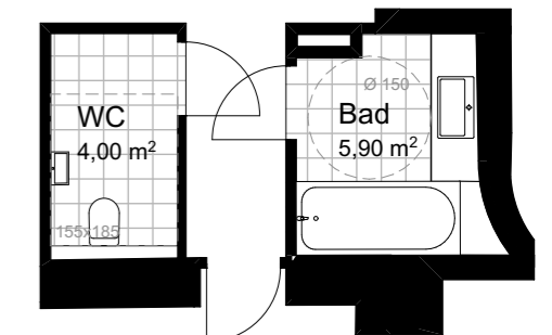
VARIANTE BARRIEREFREIE SANITÄRRÄUME M 1:100
